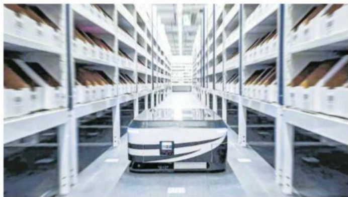
Un robot Agv per la movimentazione e la gestione del magazzino automatico delle lenti oftalmiche a Sedico
